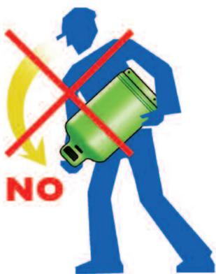
La bombola deve rimanere sempre verticale, con il rubinetto in alto. La sostituzione della bombola deve essere eseguita con il rubinetto chiuso. Non bisogna effettuare la sostituzione in presenza di fiamme, scintille o apparecchi elettrici in funzione. I tubi che sono collegati alla bombola devono essere cambiati ogni 5 anni. La bombola vuota non deve essere gettata o abbandonata ma va riconsegnata al rivenditore dal quale si acquista la bombola piena.
